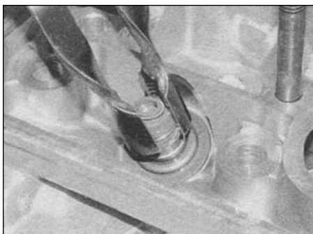
14.6а. Снимите маслосъёмные колпачки с верхней части втулок...
