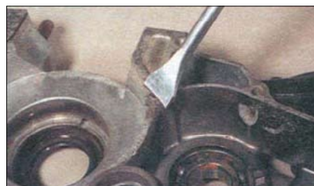
7.3. Остатки бумажной прокладки можно удалить специальным скребком...
