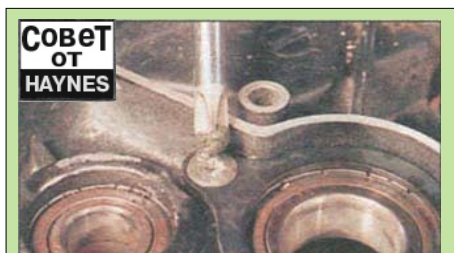
Совет от HAYNES Капля шлифовальной пасты на головке винта часто может обеспечить хорошее сцепление отвёртки с ним.
