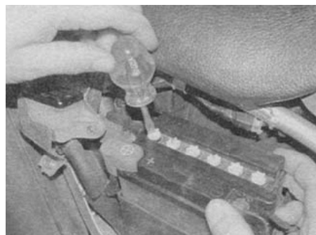
6.3а. Выкрутите пробки ячеек...
