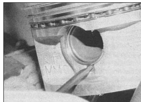
16.3а. Снимите стопорное кольцо поршневого пальца с одной стороны
