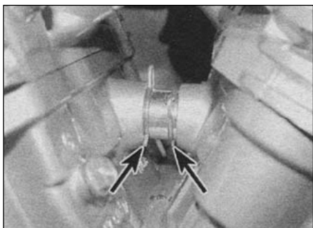
15.3. Снимите один из фиксаторов (указаны стрелками) и сдвиньте патрубок до выхода из блока
