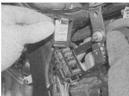
5.3д. ...чтобы получить доступ к предохранителям
