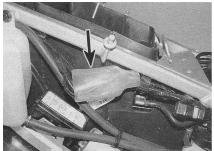
10.4. На моделях XRV750 разъём проводки заднего фонаря и указателей поворота в чехле (указана стрелкой)
