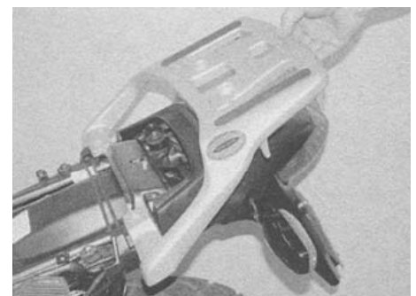
5.22в. ...и снимите багажник...
