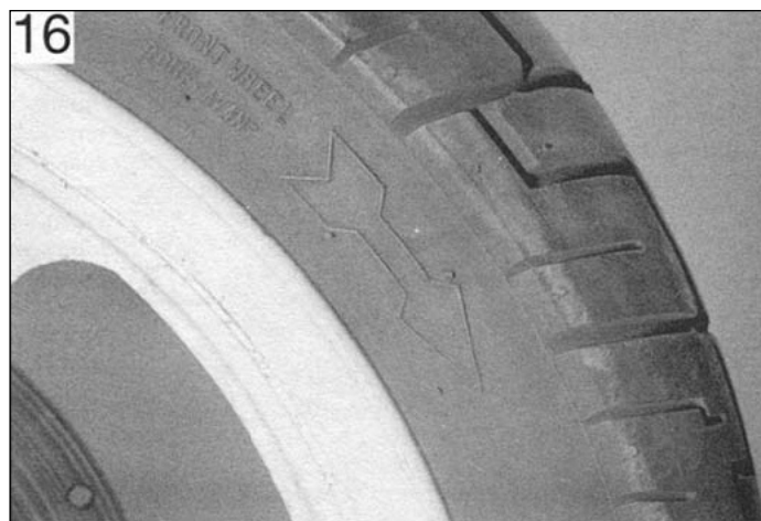
На боковине шины может иметься стрелка, указывающая нормальное направление вращения колеса
