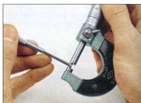
3.10. ...затем измерьте ширину нутромера микрометром
