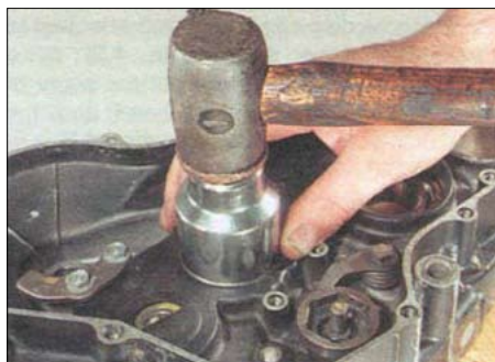
5.2. Использование большой гаечной головки по размеру подшипника
