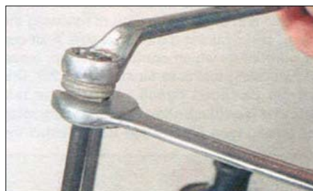
2.18. Две заблокированные друг с другом гайки позволят выкрутить шпильку
