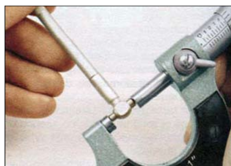
3.8. ...затем измерьте ширину нутромера микрометром
