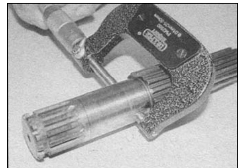
31.20г. ...и наружный диаметр шейки вала
