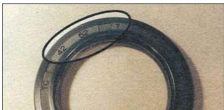
6.2. Маркировка сальника указывает его внутренний и наружный диаметры и толщину (в мм)
