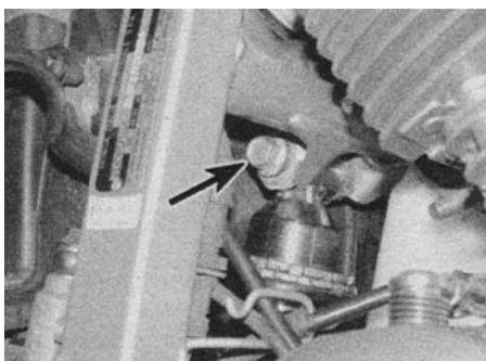
11.5а. Открутите гайку болта (указана стрелкой)...
