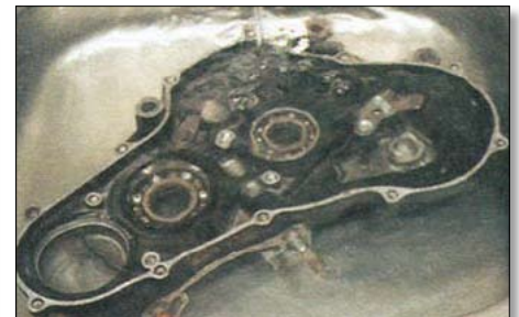
5.12. Корпус можно погрузить в ёмкость с горячей водой
