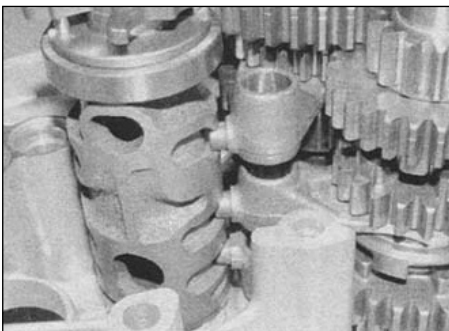
29.27. Заведите штифты вилок в канавки на селекторном барабане
