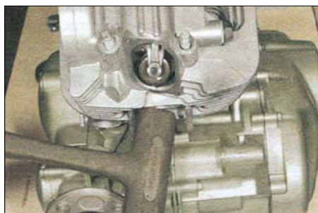
7.2. Постучите, если нужно, мягким или деревянным молотком. Не ударяйте по рёбрам охлаждения
