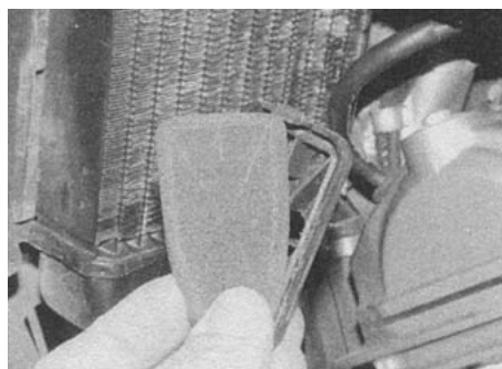
8.7б. ...и выньте фильтрующий элемент – показано для модели XL600V
