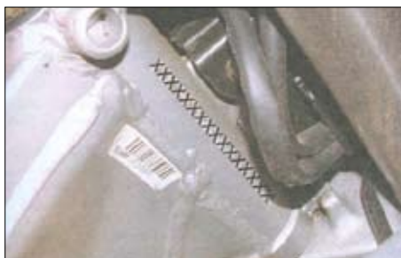
Номер рамы выбит с правой стороны цапфы рулевой колонки
