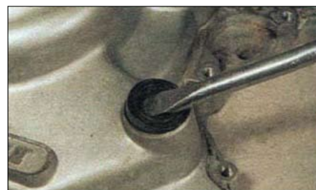
6.1. Удаление сальника плоской отвёрткой
