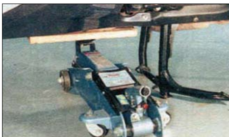
1.4. Всегда используйте деревянный брусок между картером двигателя и головкой подъёмного устройства
