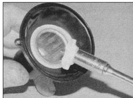
10.10. Вставьте держатель с иглой и пружиной в поршень, нажмите на него и поворачивая закрепите его за выступы
