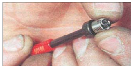
2.28. ...наденьте вставку на вороток, захватив её за нижний язычок...
