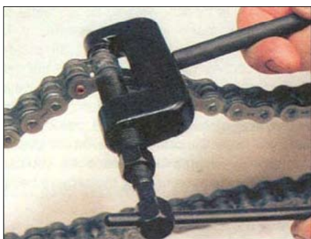
8.8. Закрутите зажим до полного и надёжного расклёпывания пальца
