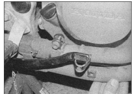
13.3д. ...и снимите трубу
