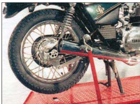
1.2. Стропы, держащие мотоцикл за его пассажирские подножки
