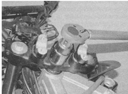
9.11б. ...и затяните гайку рулевого вала с предписанным моментом
