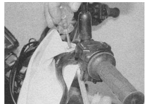
5.15б. Удерживая головку винта, открутите нижнюю гайку...
