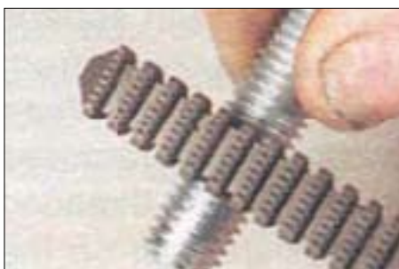
2.24. Использование «реставратора» для наружной резьбы
