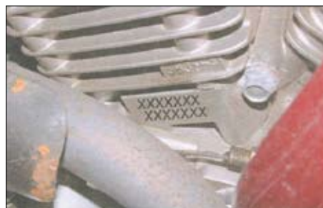
Номер двигателя выбит на правой стороне его картера
