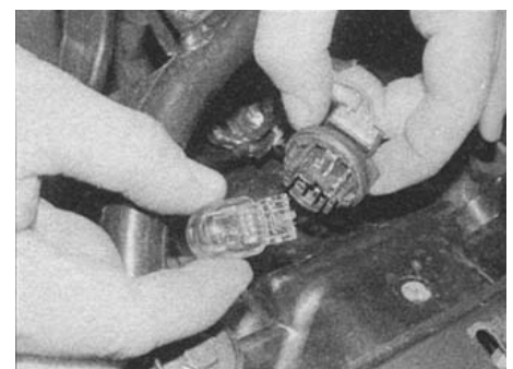
9.3б. ...а затем лампочку из патрона
