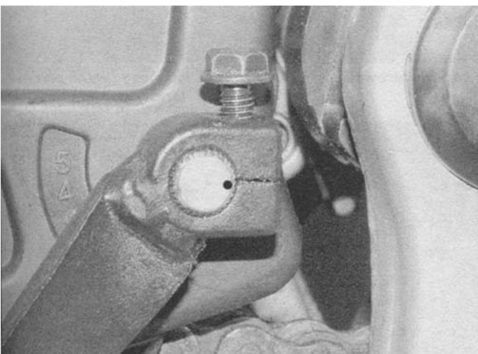
3.8. Обратите внимание на специальную метку для выравнивания рычага, затем открутите болт и снимите рычаг
