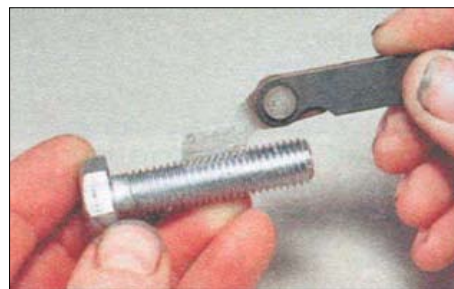
2.12. Использование резьбового калибра (резьбомера) для измерения шага резьбы
