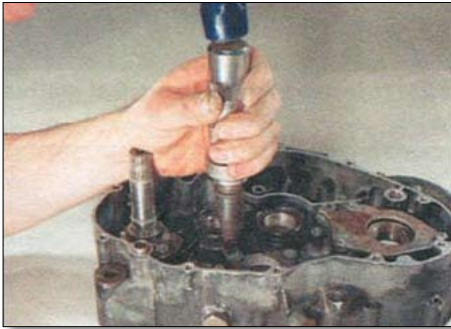
2.14. Использование ударной отвёртки для ослабления крепежа
