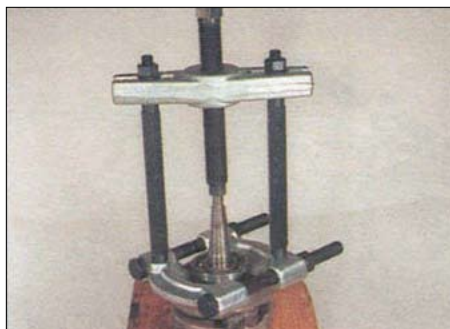
5.3. Снятие подшипника с помощью съёмника, опираемого на торец вала
