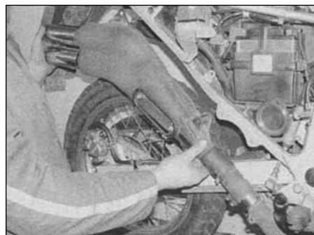
13. 2г. ...и снимите глушитель
