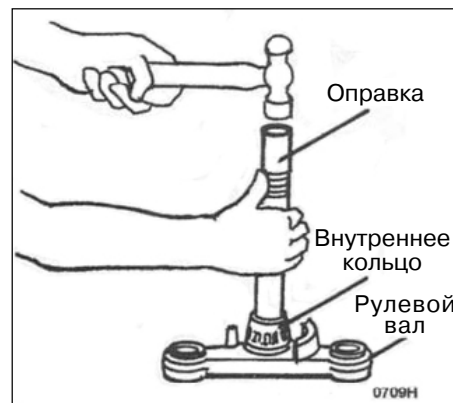
10.9. Установите новое кольцо подшипника, используя подходящую оправку или длинную трубку, которая будет опираться на внутренний край кольца
