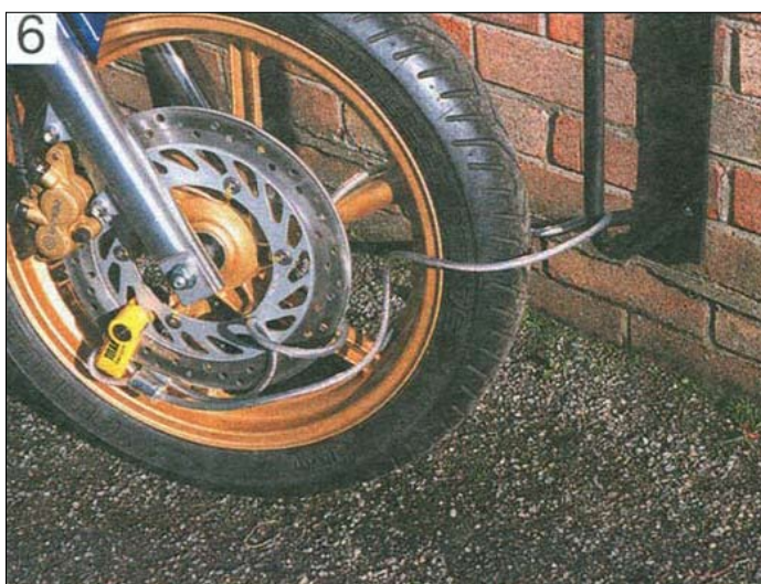
Блокиратор в сочетании с тросом обеспечивает дополнительную защиту
