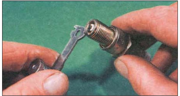
Регулировка зазора между электродами – аккуратно согните боковой электрод с помощью специального инструмента.
