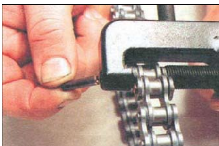
8.2. ...выньте палец, снимите зажим...
