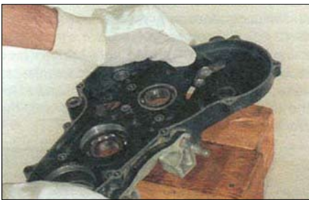
5.8. Ударяя корпусом по деревянным брускам можно выбить подшипник
