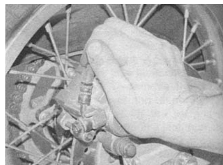
2.31. Прижмите суппорт к диску, чтобы поршень отошёл назад
