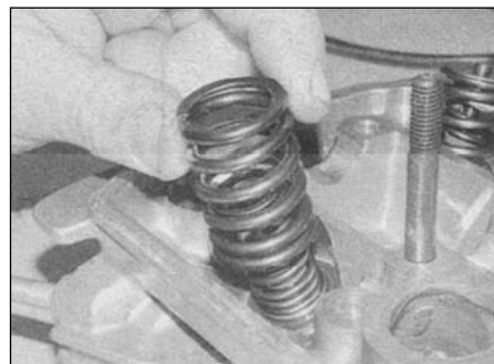
14.28б. ...а затем внешнюю пружину...
