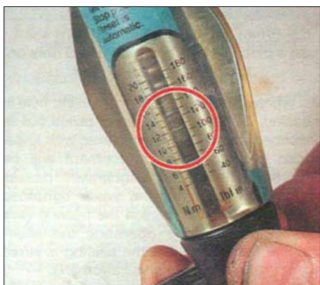
4. 1. Настройте динамометрический ключ на нужное значение момента, в данном случае – 12 Нм
