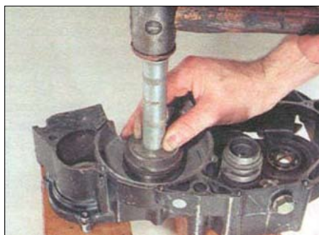
5.1. Использование выколотки, опираемой на внешнее кольцо подшипника
