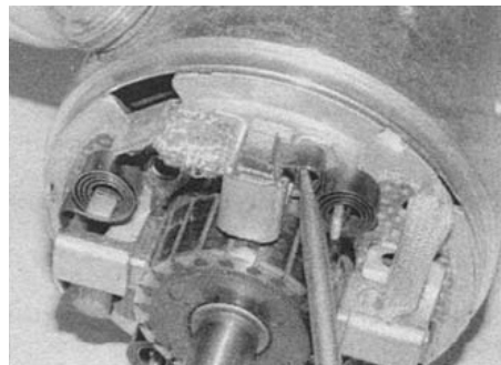
29.17. Расположение пружин на щётках
