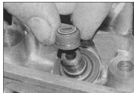
14.26а. Наденьте на втулку новый маслосъёмный колпачок...
