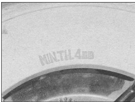
3.9а. Минимально допустимая толщина промаркирована на каждом диске
