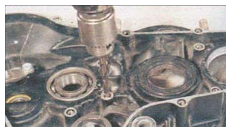
2.26. Сначала рассверлите отверстие с испорченной резьбой,...
