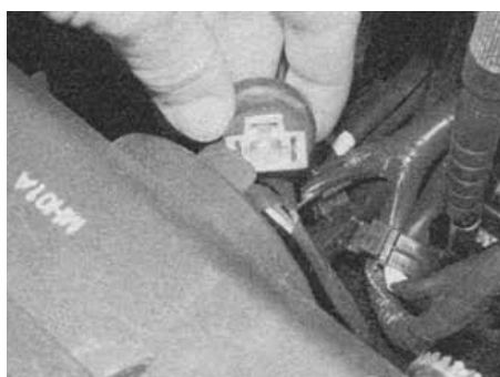
5.8в. ...отсоедините контактную колодку фары...
