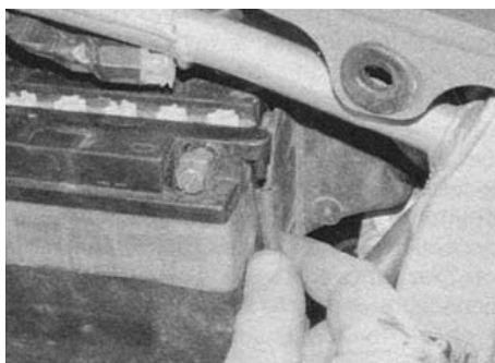
3.3в. Отсоедините газоотводную трубку
