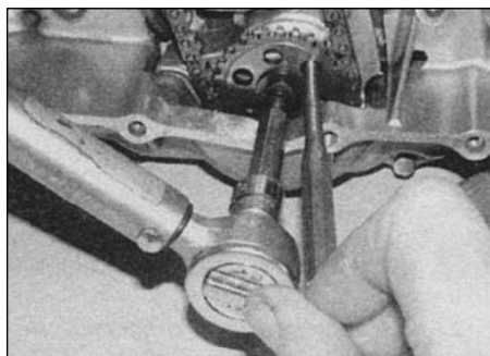
18.25е. ...и застопорив звёздочку как показано, затяните болт с нужным моментом
