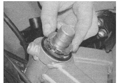
9.4а. Открутите и снимите регулировочную гайку...
