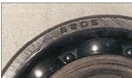
5.16. Типичная маркировка подшипника
