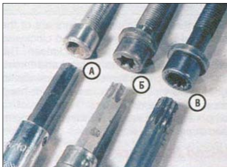
2.1. Винты с внутренними головками: шестигранник Allen (А), Тогх (Б) и шлицевым (В) и соответствующие им биты
