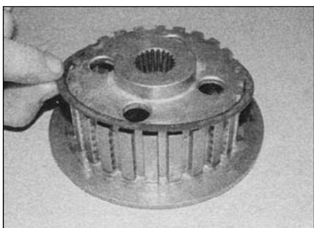
18.29. Установите седло демпферной пружины...
