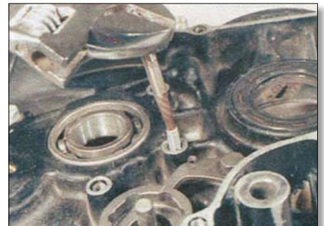
2.20. ...а затем заворачивайте экстрактор против часовой стрелки
