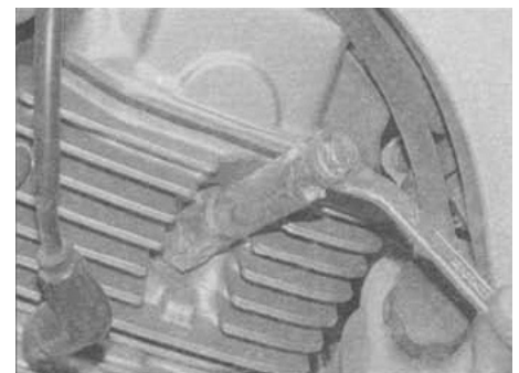
5.5б. Если Вы используете свечной ключ Honda, наденьте его на свечу зажигания и проворачивайте его накидным гаечным ключом
