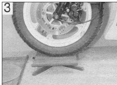
Переднее колесо установлено на пластину для проверки люфта подшипников рулевой колонки
