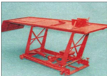
1.1. Мотоциклетная раampa с гидравлическим подъёмником
