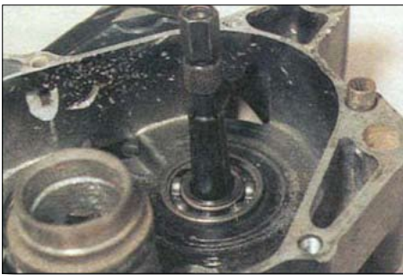
5.6. Раздвиньте цанги съёмника, чтобы они прочно захватили подшипник...
