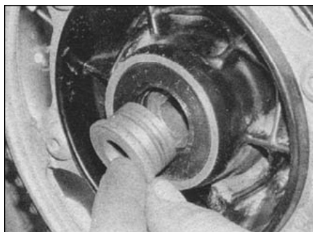
14.25б. ...и с левой стороны, отмечая их положение
