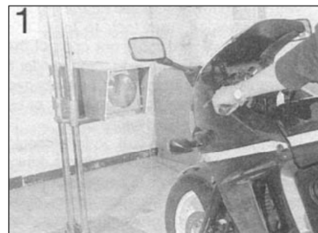
Оборудование для проверки регулировки света фар
