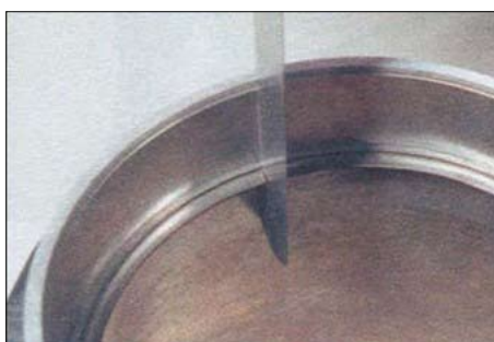
3.1. Щупы используются для измерения небольших щелей и зазоров – их толщина нанесена на лицевой стороне
