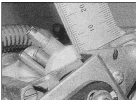
10.8. Измерьте высоту поплавка
