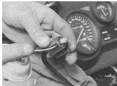
12.3а. Смазка тросика под давлением с помощью адаптера. Убедитесь в надёжной фиксации инструмента
