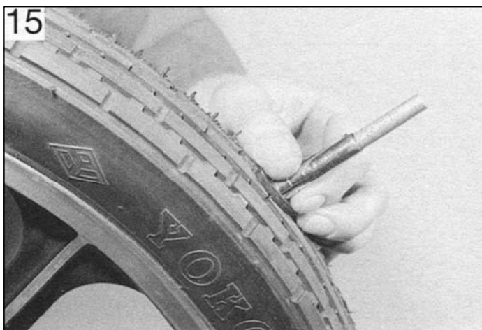
Проверка глубины протектора шины
