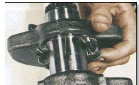
3.15. Разместите полоску Plastigauge поперёк шейки вала
