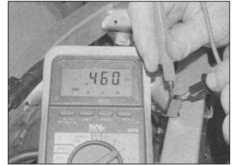
4.6. Измерение сопротивления катушки импульс-генератора
