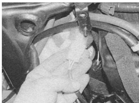
32.16. Контактный разъём генератора – XL650V
