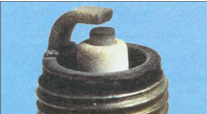
Нормальное состояние – коричневый, жёлто-коричневый или серый цвет электродов указывает, что двигатель находится в хорошем состоянии и зазор правильно отрегулирован.
