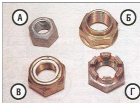
2.4. Гайки: простая гайка (А), контрящаяся (Б), с нейлоновой вставкой (В) и корончатая (Г)
