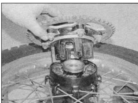
15.13. Выньте звёздочку в сборе из ступицы колеса
