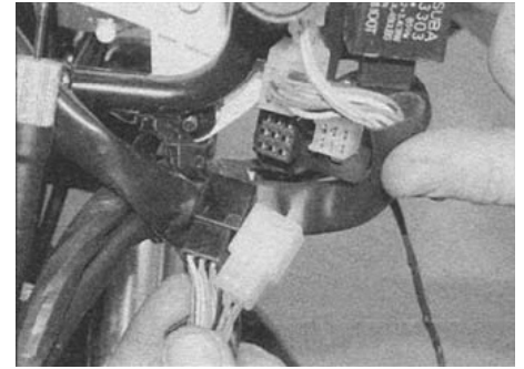
15.3б. Контактная колодка приборной панели – XL650V
