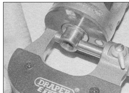
29.15. Измерьте диаметр шейки селекторного барабана
