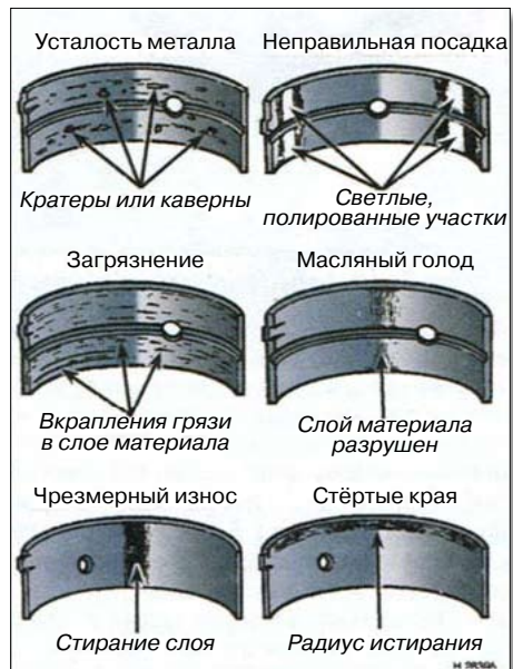
5.17. Типичные дефекты подшипников скольжения
