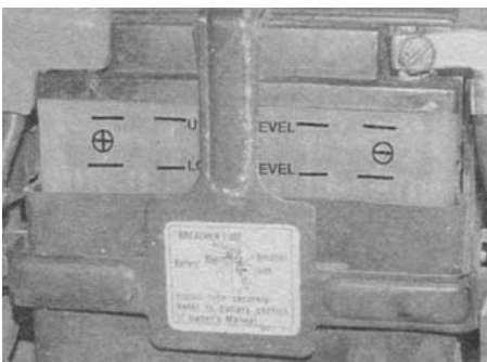
6.2. Убедитесь, что уровень электролита в каждой ячейке находится между верхней и нижней отметками
