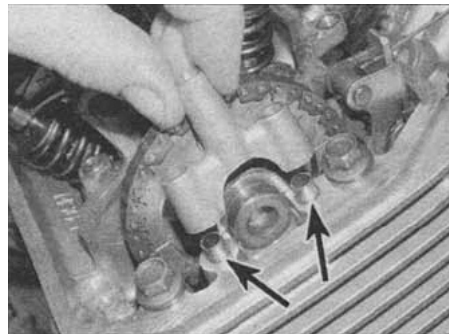
9.4. Снимите держатель на конце распределвала и его направляющие (показаны стрелками), если они вынимаются
