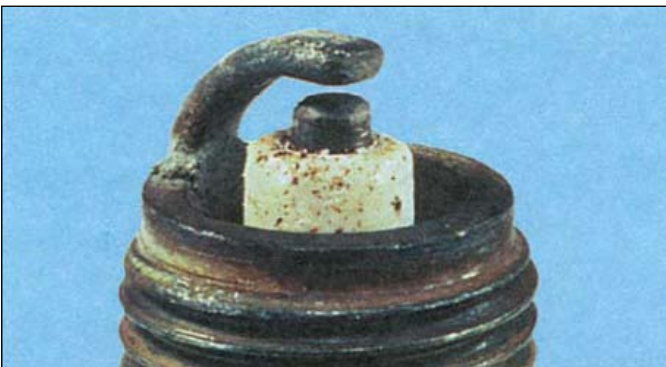
Перегрев – покрытый волдырями белый изолятор и застеклевшие электроды – неисправность системы зажигания, некачественное топливо или неисправность системы охлаждения.
