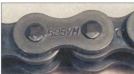
8.10. Типичная маркировка цепи
