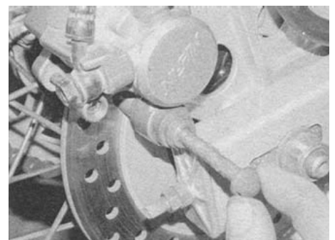
2.35в. Вставьте болт и надёжно его затяните
