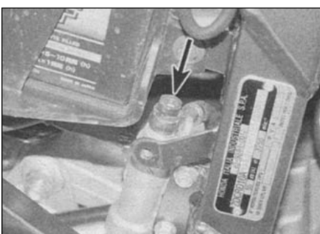
8.5. Гидравлический болт тормозного шланга (указан стрелкой)
