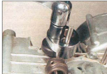
2.17. Использование экстрактора-шпильковёрта для удаления сломанных шпилек из картера
