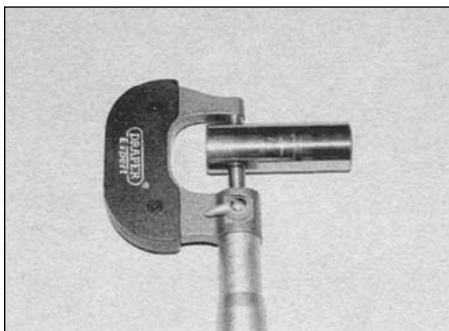
16.12б. Измерьте наружный диаметр пальца...
