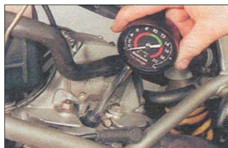
3.20. Использование компрессометра с конусным резиновым наконечником
