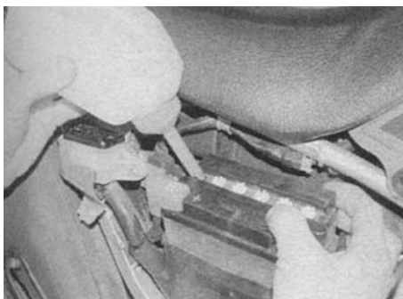
8.3б. ...И долейте до верхней отметки дистиллированную воду
