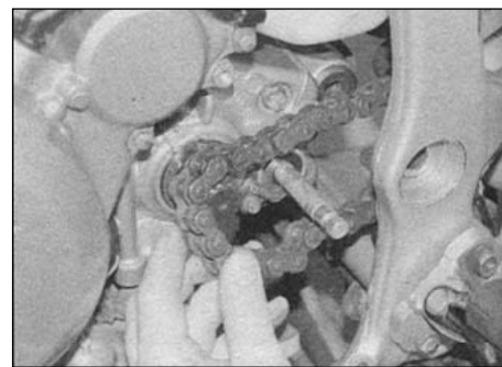
5.26б. Снимите приводную цепь со вторичного вала КПП
