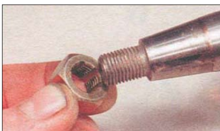
2.23. Инструмент для ремонта наружной резьбы
