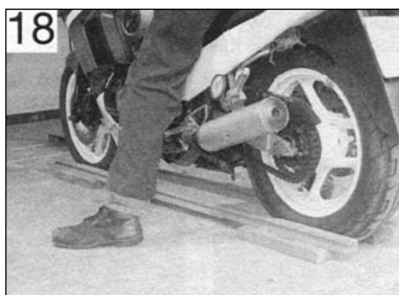
Проверка установки колес с помощью двух длинных прямых брусков
