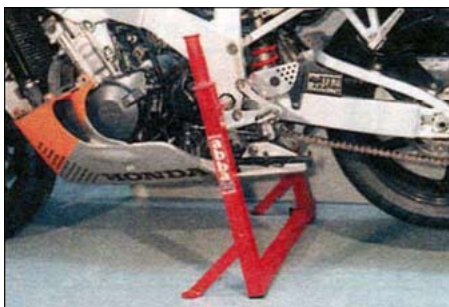
1.3. Эта вспомогательная подставка крепится к оси маятниковой вилки
