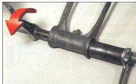
5.10. Снятие (выталкивание) подшипника из рычага подвески
