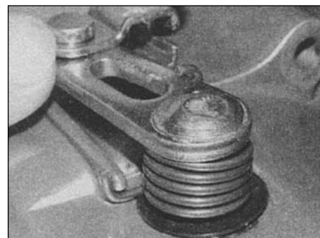
18.21г. ...и концы пружины правильно расположены
