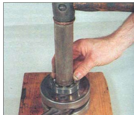
5.5. При установке подшипника на вал используйте отрезок трубы, опирая его только на внутреннее кольцо
