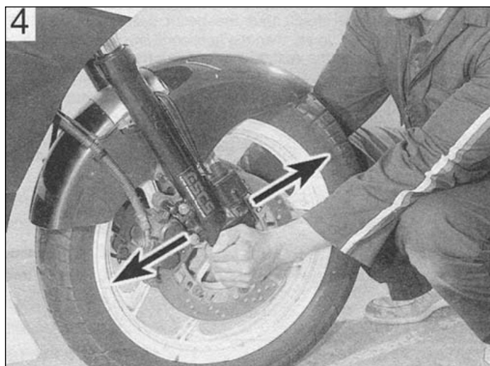
Проверка на люфт подшипников рулевой колонки
