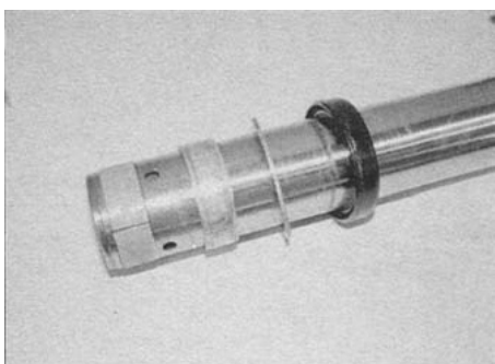
8.11б. ...скользяще-ударным воздействием снимите сальник и втулку
