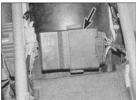
5.3а. Блок управления зажиганием (указан стрелкой) – XL600V
