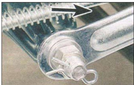
2.7. Правильная установка R-шплинта Стрелка указывает направление движения
