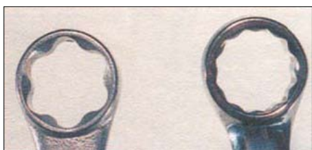
2.21. Сравнение типов накладных гаечных ключей: 6-гранного (слева) и 12-гранного (справа)
