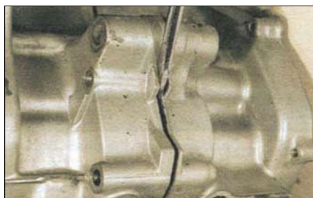
7.1. Если есть точка для рычага, осторожно нажимайте плоской отвёрткой
