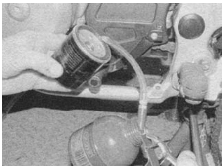
13.7а. Смажьте прокладку и резьбу свежим маслом...
