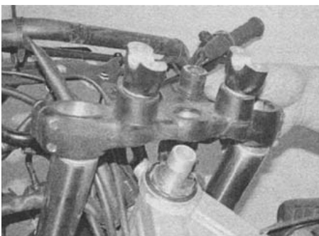
19.8в. ...и снимите верхнюю траверсу
