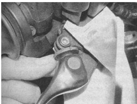
19.6. Регулировка просвета рычага переднего тормоза
