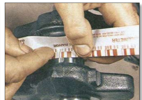
3.16. Измерение ширины расплющенной полоски Пластигейдж
