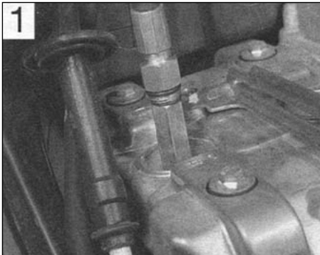
1 Вкрутите в свечное отверстие адаптер измерителя компрессии, а затем вкрутите прибор в адаптер
