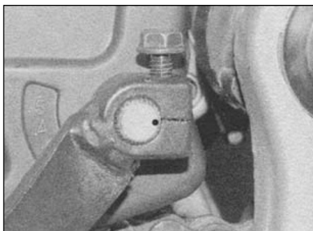
20.2а. Обратив внимание на установочную метку, открутите болт и снимите рычаг
