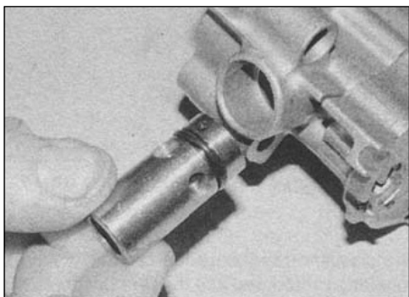
25.12а. Выньте клапан из насоса
