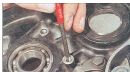
2.30. Обломите оставшийся внизу язычок, и операция полностью завершена
