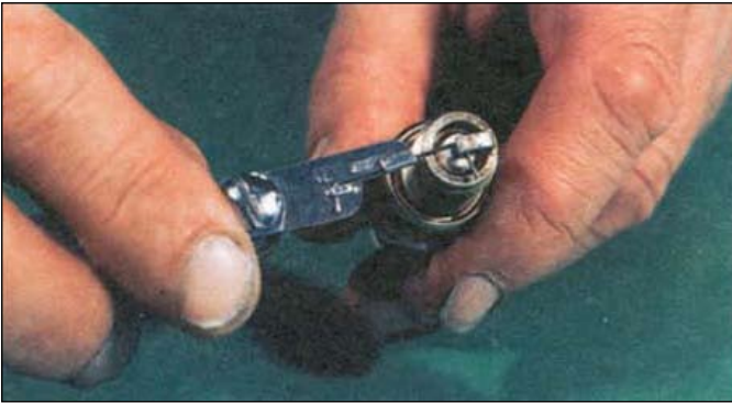
Проверка зазора между электродами – лучше всего использовать щуп проволочного типа.
