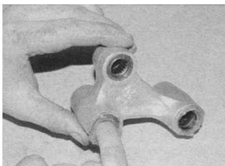
12.11. Смажьте подшипники пластичной смазкой
