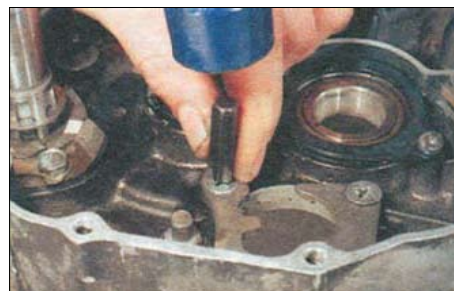
2.13. Резкий удар по головке «упрямого» винта позволит его стронуть
