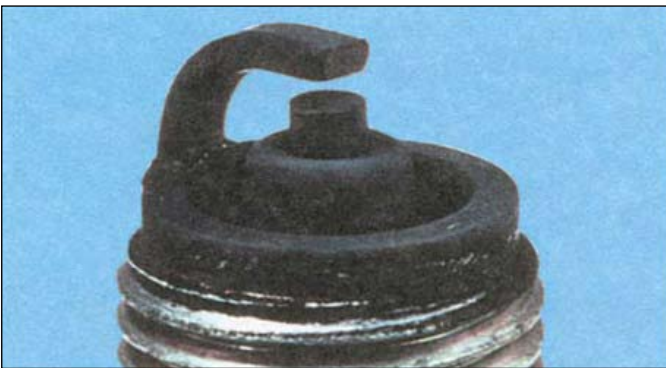
Сажевые загрязнения – сухие, чёрные, закопченные электроды, ведущие к пропускам и слабой искре – чрезмерно богатая смесь, заедание дросселя или засорение воздушного фильтра.
