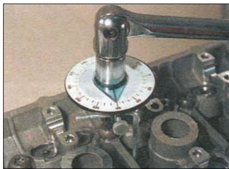
4.2. Угол затяжки можно проверить по транспортиру...
