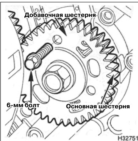
18.11. Выровняйте зубья шестерни и вставьте 6-мм болт в отверстие для блокировки её
