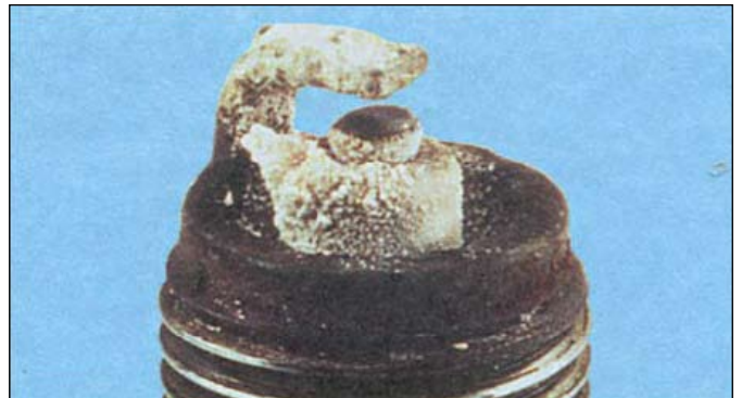
Нагар – много светло-коричневого нагара на электродах и изоляторе, ведущего к пропускам искры – много масла попадает в камеру сгорания или низкое качество топлива или масла.
