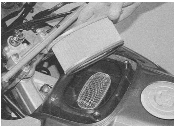
8.3в. ...и достаньте фильтрующий элемент
