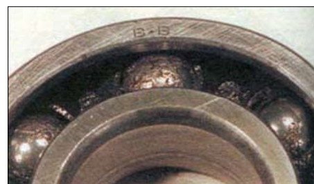
5.18. Пример подшипника с повреждёнными шариками и сепаратором
