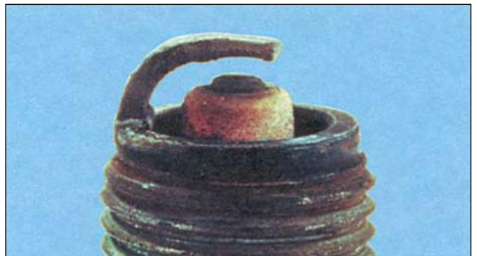
Изношенная свеча – выгоревшие электроды приведут к ухудшению пуска во влажных или холодных условиях, а также к повышенному расходу топлива.
