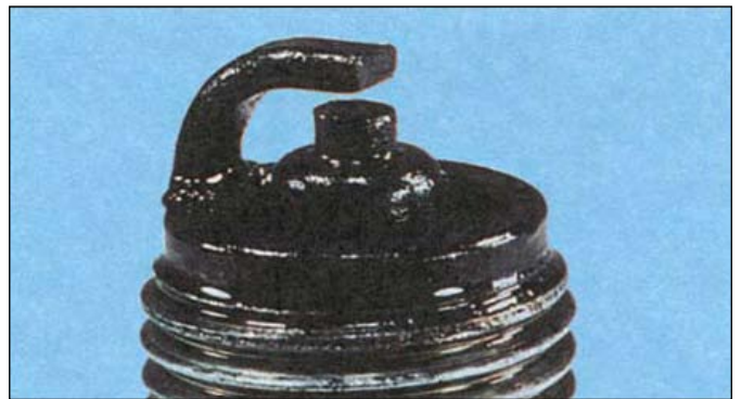
Замасленная свеча – пропускание масла изношенными поршневыми кольцами или направляющими втулками клапанов (4т-двигатель), или избыток масла в топливе (2т-двигатель).
