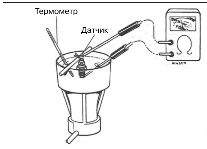
3.14. Установка датчика для проведения испытания
