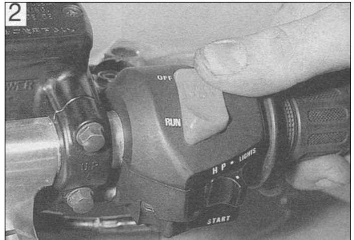
2 Поставьте аварийный выключатель в положение «OFF» (Выключено)...
