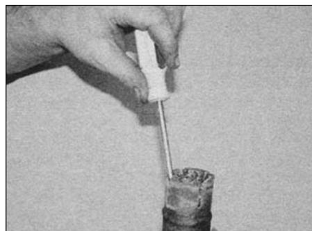
13.7а. Снимите старое уплотнительное кольцо...
