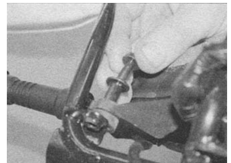
15.11б. ...затем открутите болты и снимите втулки
