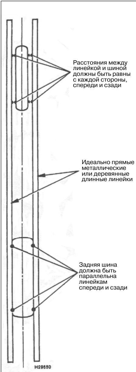
12.7. Проверка выравнивания колес с помощью линеек
