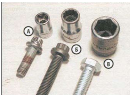
2.2. Болты с внешними головками: Тогх (А), шлицевые (Б) и шестигранные (В) и соответствующий инструмент
