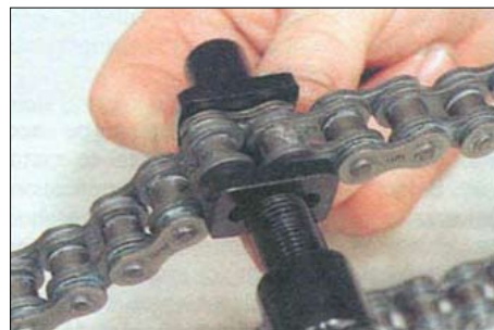
8.7. Возмите боковую пластину на пальцы до упора
